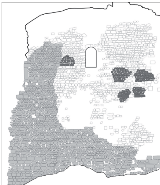
Figura 3 - Posizionamento 2D di cinque blocchi (in grigio scuro) ottenuto mediante analisi comparativa della tessitura muraria del perimetrale est ripreso nelle diverse immagini "storiche" (in bianco); in grigio chiaro, l'alzato tutt'oggi conservato
