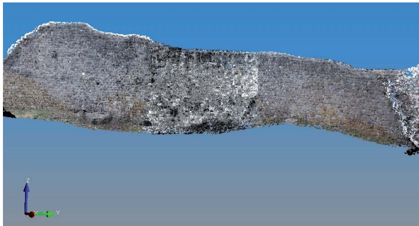
Figura 2 – Particolare della cinta interna del castello: si noti al centro la nuvola di punti con i valori di riflettanza in toni di grigio, mentre, ai lati, la stessa scansione texturizzata
