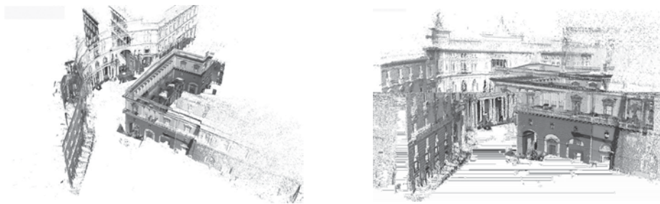
Figura 1 – Nivole di punti dell'esterno del Teatro San Carlo e dell'area circostante
